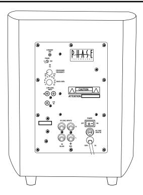
**[FEATURES]** • 250-WATT AMPLIFIER • SIGNAL SENSING AUTO TURN ON/OFF • GAIN CONTROL • PHASE SWITCH • VARIABLE CROSSOVER • LINE LEVEL/ HIGH LEVEL INPUTS • LFE INPUT • OVERSIZED SURROUND FOR ULTRA LONG EXCURSION • SERVO-CONTROL MONITORS AND ADJUSTS OUTPUL FOR DYNAMIC AND UNDISTORTED RESPONSE
