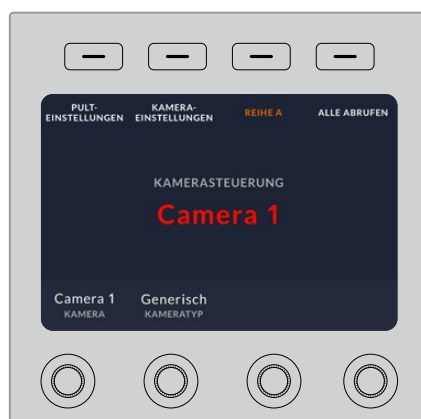
An dem auf der LCD-Startseite eingeblendeten Kameranamen bzw. an der Kameranummer ist zu erkennen, welche Kamera aktuell für eine CCU ausgewählt ist
