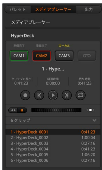
HyperDeckパレットのボタンを使用して4台までのHyperDeckを選択
