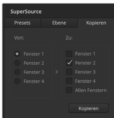
Kopieren der Einstellungen für Fenster 1 nach Fenster 2
