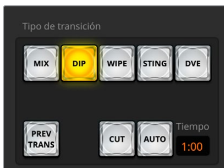
El botón CUT forma parte del módulo de transiciones.
