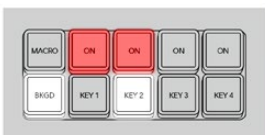
コントロールパネルのネクスト・トランジションボタン。トランジション前。
