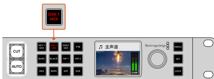
按 DSK 1 MIX 按钮将下游键1通过淡入淡出的方式带入或带出播出状态
