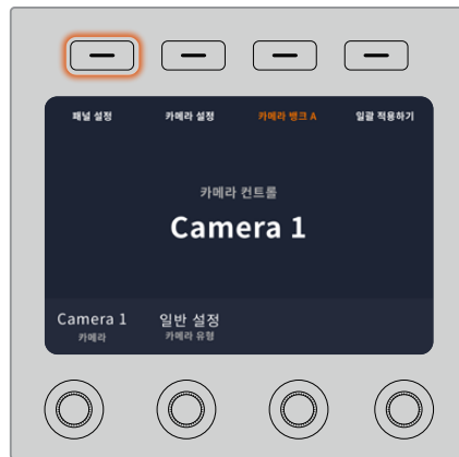
LCD 시작 화면에서 '설정' 소프트 버튼을 누르면 카메라 제어 패널의 모든 설정에 접속할 수 있습니다.
