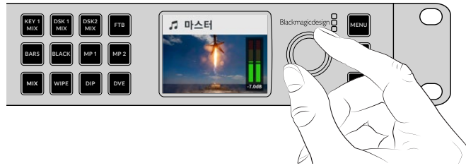
노브를 사용해 마스터 오디오 레벨을 조절하고 LCD에 나타나는 오디오 미터를 통해 조절을 확인할 수 있습니다.
