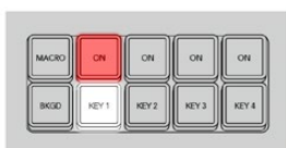
图为控制面板中Next Transition下一个转场按钮在转场前的状态。
