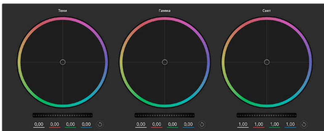
Цветовые круги для работы с параметрами тени, полутона и света на панели цветокоррекции
