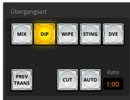
Die Hartschnitttaste CUT ist eine der Übergangsarttasten
