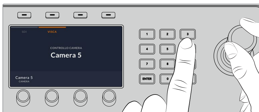
Seleziona la camera che vuoi controllare e muovi il joystick per gestirne i movimenti PTZ
