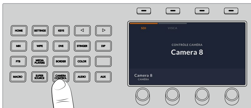
Pour activer le contrôle PTZ via VISCA, appuyez sur le bouton Camera control et sélectionnez VISCA en appuyant sur le bouton multifonction correspondant.
