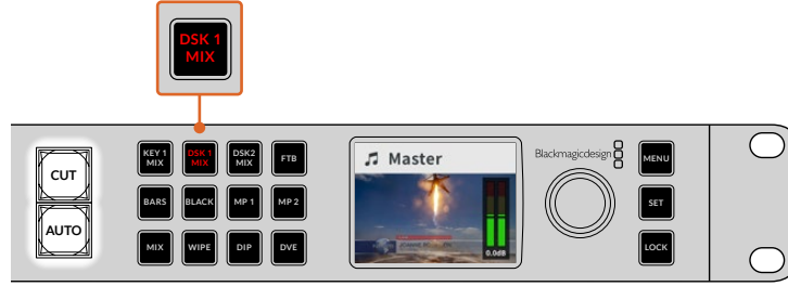
Downstream key 1'i yayına koymak ve çıkarmak için DSK 1 MIX butonuna basın.
