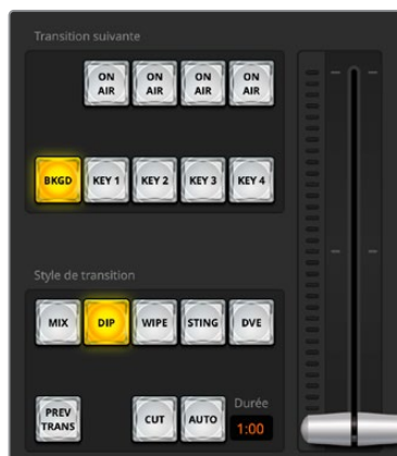
Contrôle des transitions
