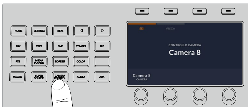
Premi CAMERA CONTROL > VISCA per abilitare il controllo PTZ
