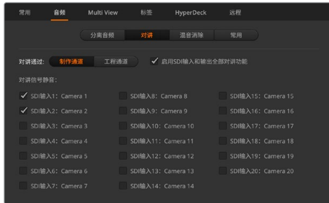
将输入上的制作对讲信号静音
