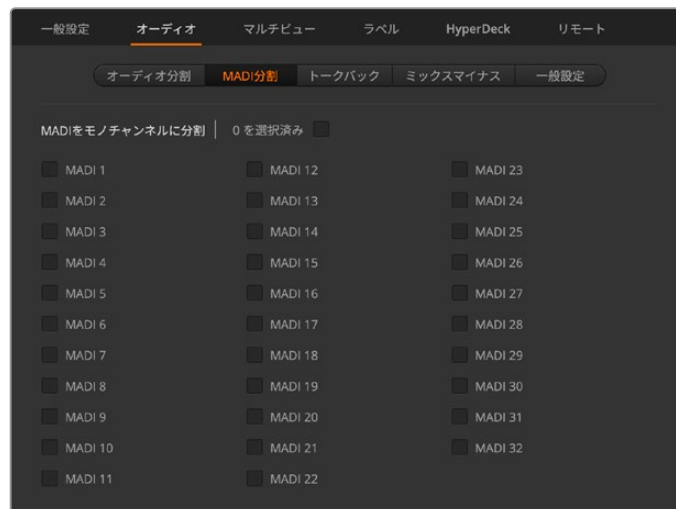
ATEM 4 M/E Constellation HDで、チェックボックスを使用して、MADIを個別のモノチャンネルに分割
