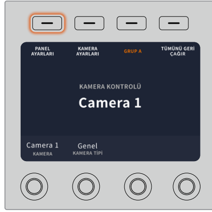
Kamera kontrol panelinin tüm ayarlarına ulaşmak için, LCD ana ekranında 'panel ayarları' yazılım butonuna basın.
