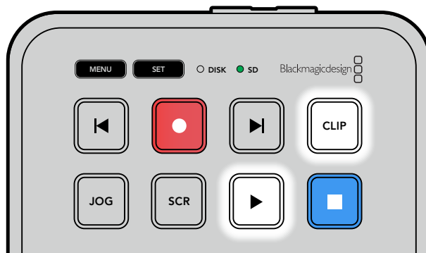
Erneutes Drücken der Wiedergabetaste im Clipmodus spielt den aktuellen Clip in Schleife ab
