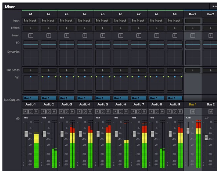
图为调音台，其多个通道条分别对应的是时间线上的多个轨道。
