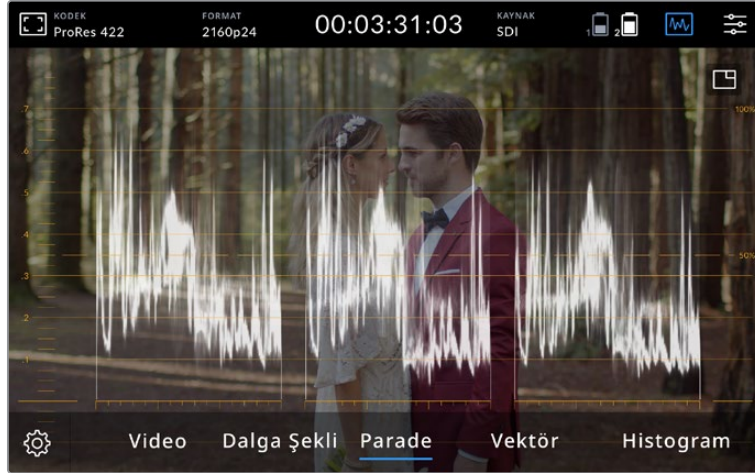
RGB parade; kırmızı, yeşil ve mavi kanalların parlaklık seviyelerini gösteren ayrı dalga şekillerini görüntüler.
