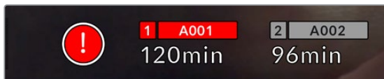
CFast 카드 1에 발생한 드롭 프레임 현상을 알리는 드롭 프레임 경고 표시
