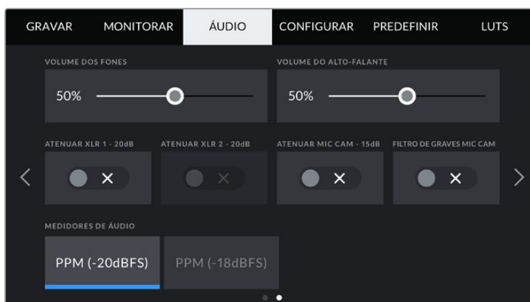
Configuração dos medidores de áudio nos modelos URSA Mini Pro 12K e URSA Mini Pro G1.
