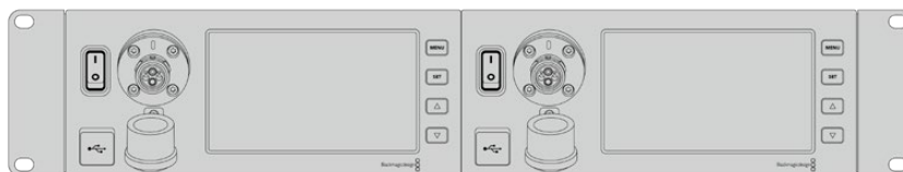
Размещение двух Blackmagic Studio Fiber Converter в стойке
