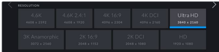
Opciones de resolución en las cámaras URSA Mini Pro 4.6K G2 y URSA Mini Pro 4.6K
