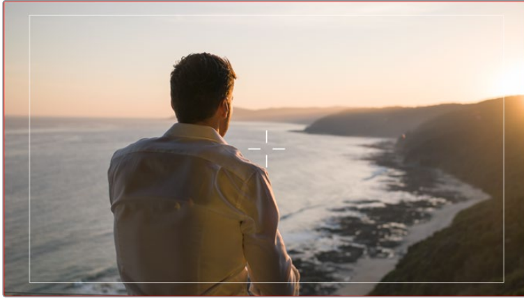
连接ATEM切换台发送Tally信号时,若启用了网格,摄影机画面预览周围会出现红色边框
