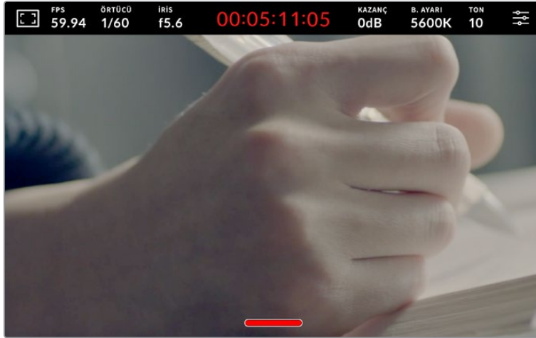
LCD dokunmatik ekrandaki ekran altı katmanları gizlemek için, parmağınızı yukarı veya aşağı kaydırın.
