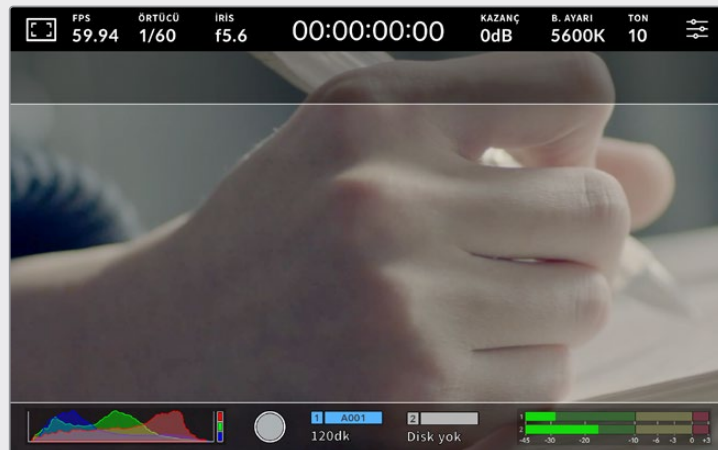
2.40:1 çerçeve kılavuzları etkinleştirilmiş dokunmatik LCD ekran
