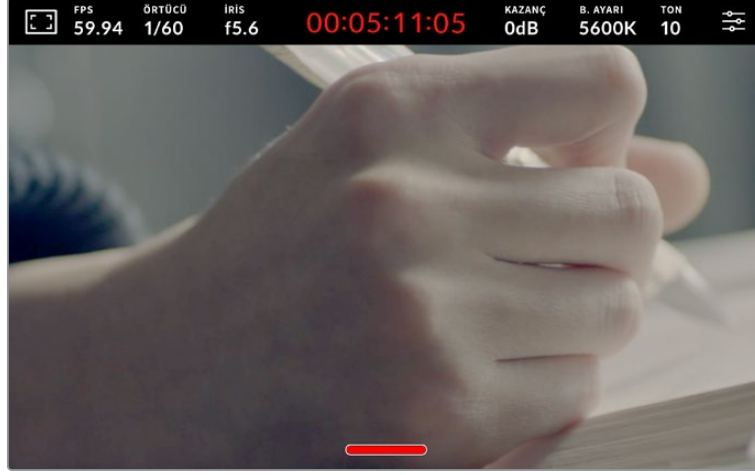
Blackmagic Studio Camera'nız, temiz sinyal modundayken bile kayıt için tally görüntüler.
