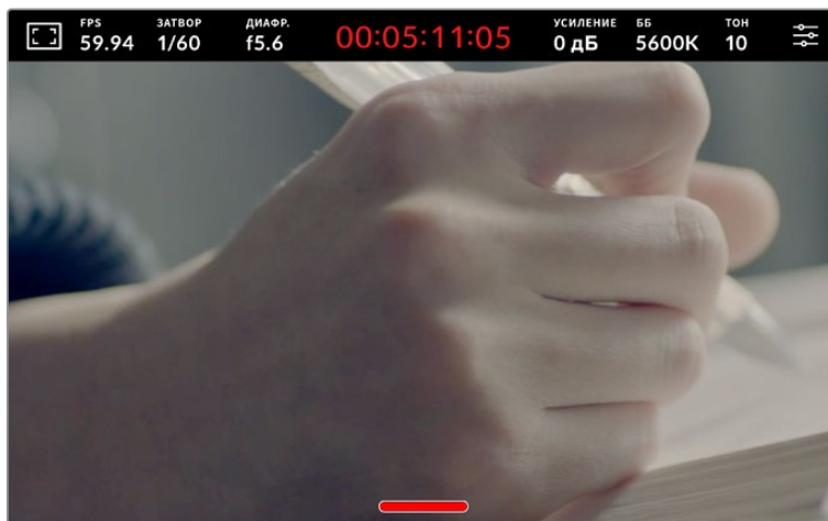
Индикатор состояния записи отображается на ЖК-дисплее даже при выводе чистого сигнала
