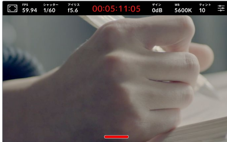
Studio Cameraは、クリーンフィードが有効になっていても収録タリを表示
