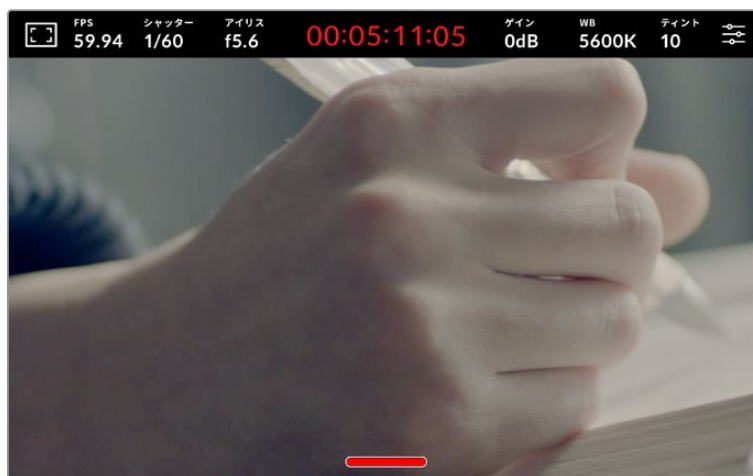
上下にスワイプして、LCDタッチスクリーンのローワーサードオーバーレイを非表示
