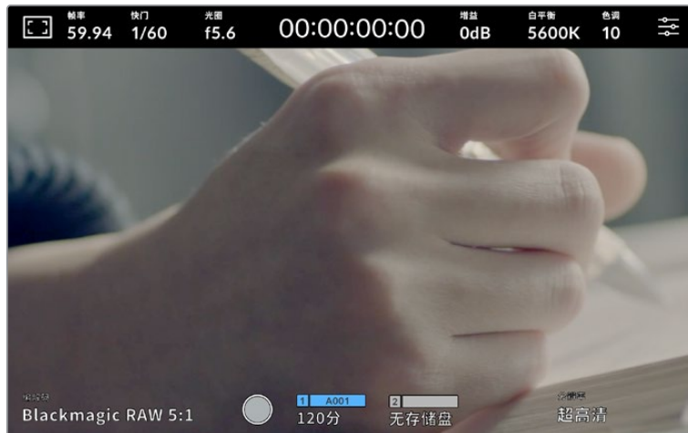
Blackmagic Studio Camera可在直方图和音频表的位置显示编解码和分辨率信息。
