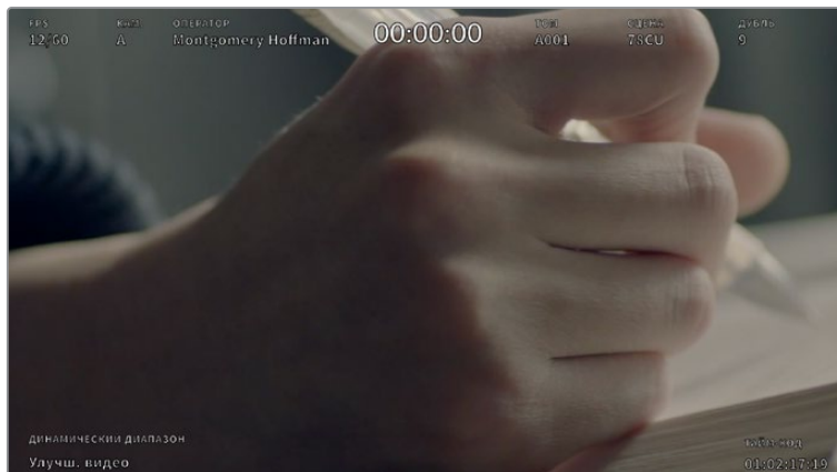
Blackmagic Studio Camera дает возможность выводить на HDMI-выход дополнительную информацию для режиссера
