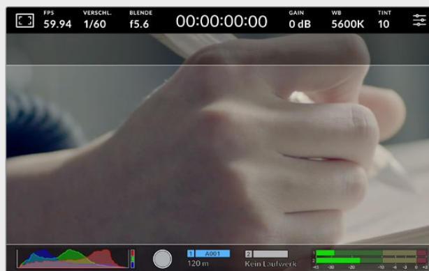
LCD-Touchscreen mit aktivierten 2,40:1-Bildrandmarkierungen
