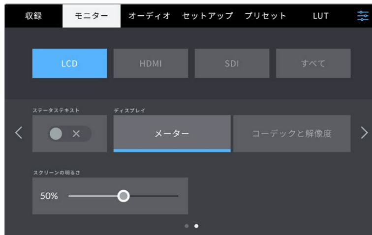
「ステータステキスト (STATUS TEXT)」を切り替えて、プレビューイメージのみを表示
