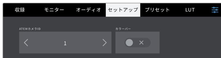
Studio Cameraの「SETUP (セットアップ)」設定でATEMカメラIDを変更
