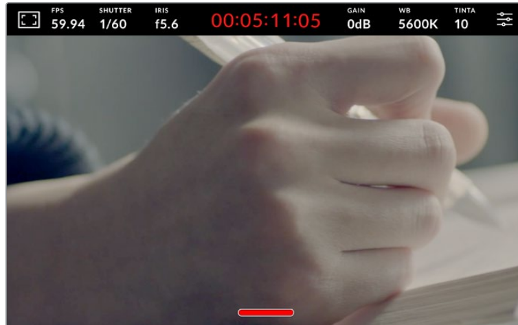
La spia tally rimane visibile in modalità clean feed
