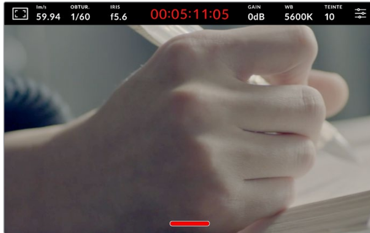
Votre Studio Camera affiche le voyant d'enregistrement tally, même en mode Clean Feed
