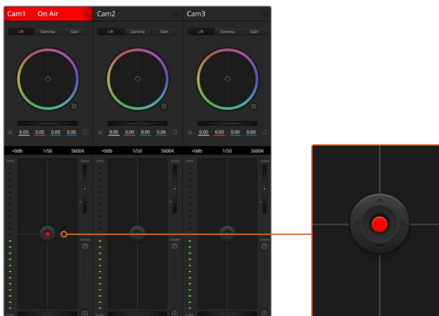
当某台摄影机处于直播状态时, 对应的光圈/黑电平控制按钮会亮起红色
