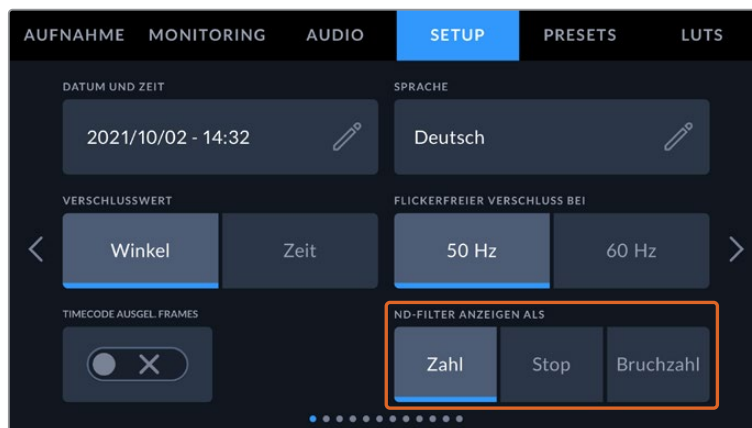
Einstellung für die Anzeige von ND-Filterinformationen im SETUP-Menü der URSA Broadcast G2
