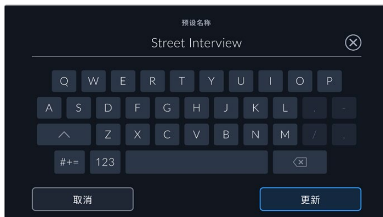
点按预设选项卡中代表“添加”的图标，再使用屏幕键盘来输入预设名称。
