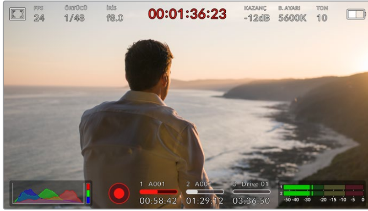
URSA Broadcast G2'nin dokunmatik LCD ekranı, kapsamlı bir denetim merkezi ekranına sahiptir ve kameranızın en sık kullanılan ayarlarına kolay erişmenizi sağlar.
