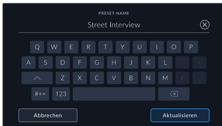
Tippen Sie auf dem PRESETS-Tab auf das Hinzufügen-Icon und geben Sie mithilfe der Tastatur einen Namen ein
