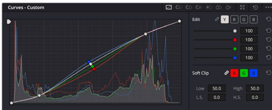
La palette Courbes est un autre outil que vous pouvez utiliser pour faire de la correction colorimétrique primaire ou pour travailler certaines zones du clip avec une Power Window
