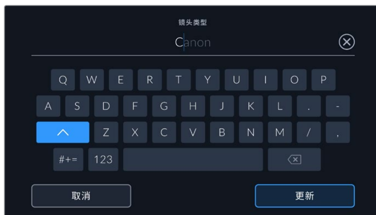
如果镜头不具备自动提供信息的功能，请使用屏幕键盘来输入镜头数据。
