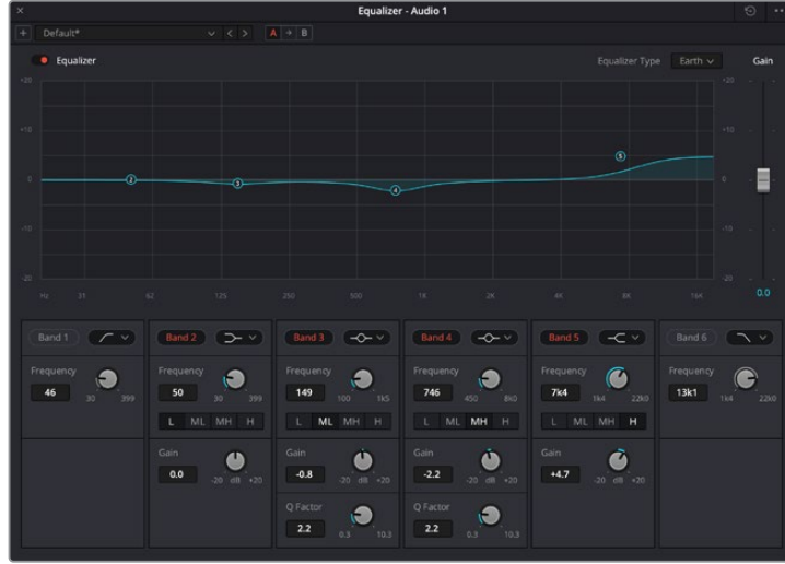
Her kanala uygulanabilen 6 bant parametrik ekolayzer
