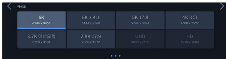
Blackmagic RAW 코덱 사용 시 Pocket Cinema Camera 6K Pro 및 6K G2의 해상도 옵션
