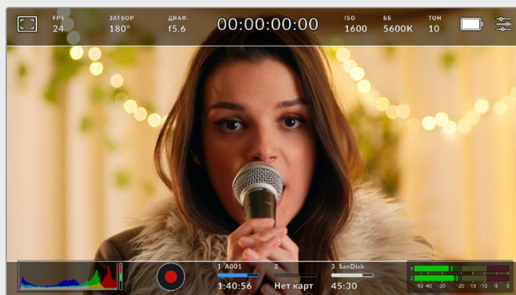
Изображение на сенсорном ЖК-экране с рамкой 2,40:1
