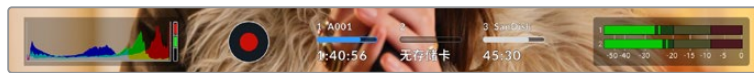
LCD触摸屏底部的存储介质提示会显示剩余记录时间或SD卡是否被锁定。
