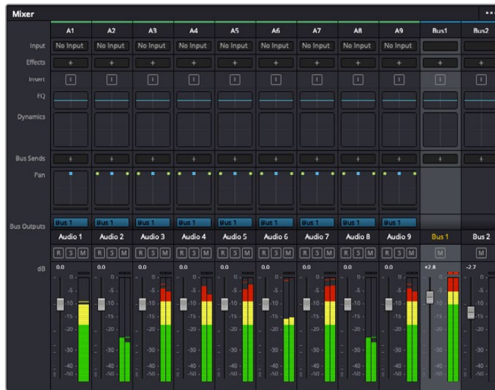
Les bandes de canal du mixeur audio, correspondant aux pistes de la timeline
