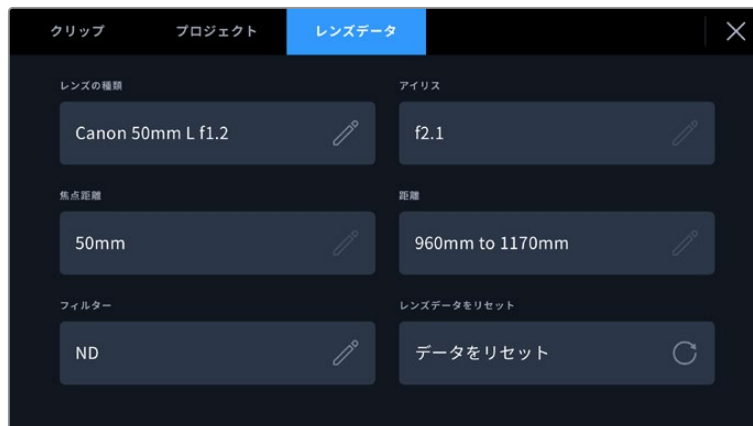
「レンズデータ (LENS DATA)」メニューでは、取り付けられたレンズからの情報と、マニュアルで入力したフィルター情報を自動的に表示
