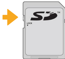
ロックタブを上下に動かしてSDカードをロック/解除
