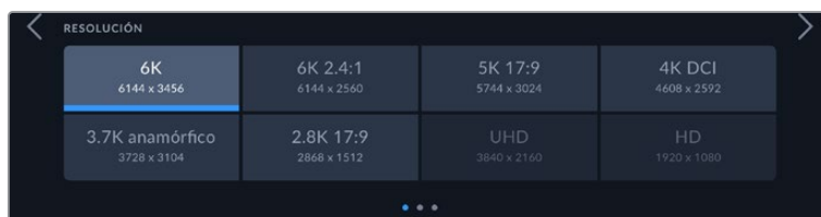
Opciones RESOLUCIÓN al grabar en Blackmagic RAW en los modelos Blackmagic Pocket Cinema Camera 6K Pro y 6K G2
