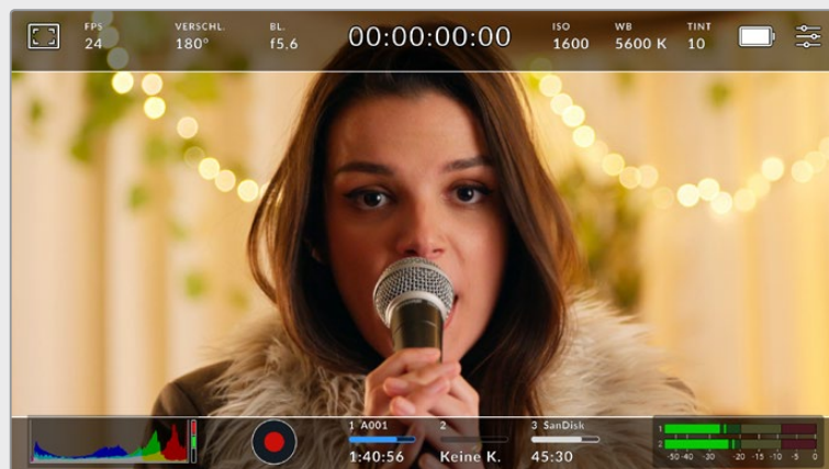
LCD-Touchscreen mit aktivierten 2,40:1-Bildrandmarkierungen
