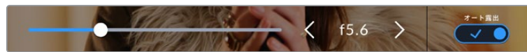
「アイリス (IRIS)」メニューでアイリスインジケータの横の矢印ボタンをタップ、あるいはスライダーを使ってアイリス設定を調整。
