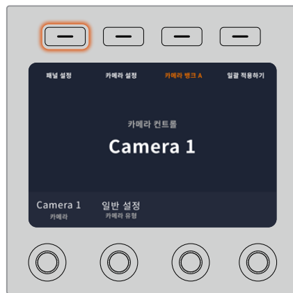
LCD 시작 화면에서 '패널 설정' 소프트 버튼을 누르면 카메라 제어 패널의 모든 설정에 접속할 수 있습니다.
