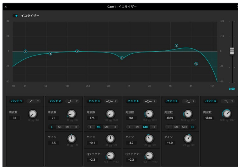
各オーディオ入力は、6バンド・パラメトリックイコライザーを搭載
