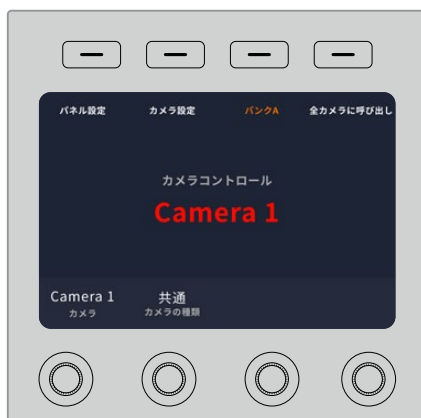
LCDホームスクリーン上のカメラ名/カメラ番号は、該当のCCUで現在選択されているカメラを表示します。
