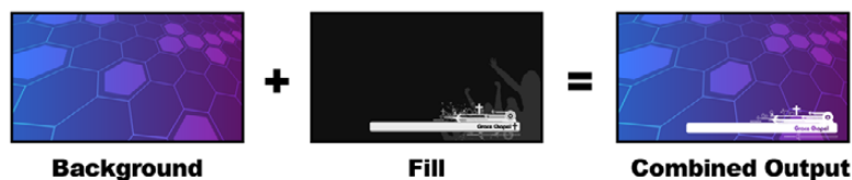
Совмещение фона и вырезающего/заполняющего сигналов при ярком кейнге
