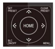
**Up**: press ▲ **Down**: press ▼ **Left**: press ◀ Right: press Return to middle position: press [HOME]
