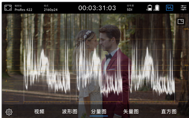
RGB分量图可分开显示红、绿、蓝色通道的亮度波形
