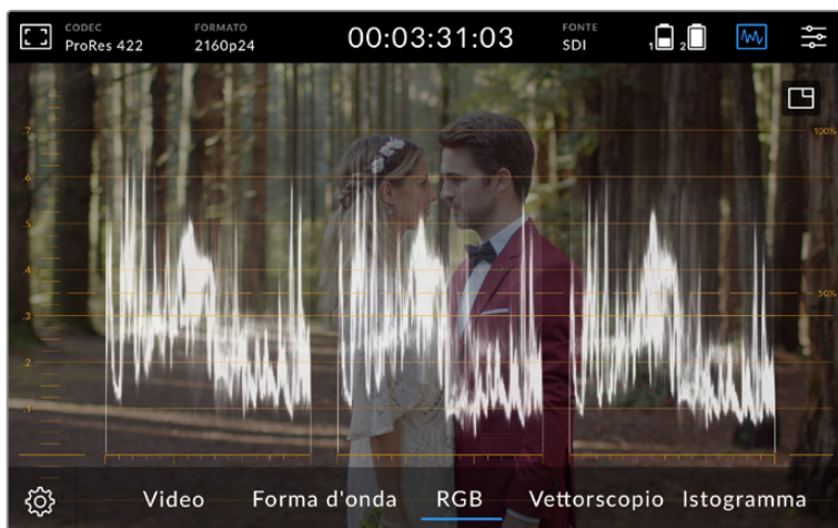
L'allineamento RGB mostra forme d'onda distinte per la luminanza dei canali rosso, verde, e blu
