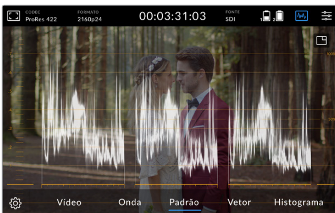
O padrão RGB exibe formas de onda separadas que indicam a luminância dos canais vermelho, verde e azul.
