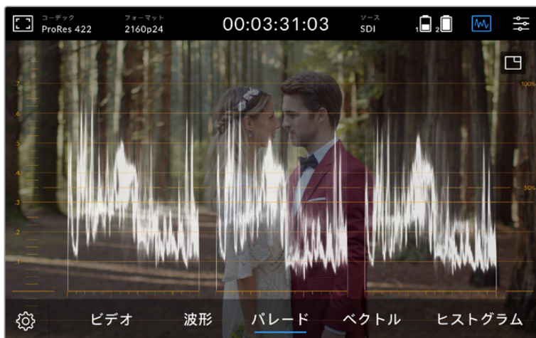
RGBパレードは赤/緑/青チャンネルの輝度を個別に波形として表示
