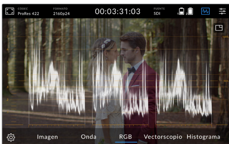
Las diferentes posiciones representan las sombras, los tonos intermedios y las luces, al lado del eje horizontal.
