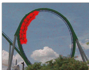
Die Rotfärbung zeigt an, auf welche Teile des Bildes temporale rekursive Rauschunterdrückung angewandt wurde.
