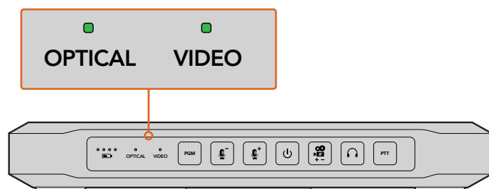
El indicador VIDEO se enciende cuando se detecta una señal SDI o HDMI válida. A su vez, el indicador OPTICAL se ilumina al conectar un cable de fibra óptica.
