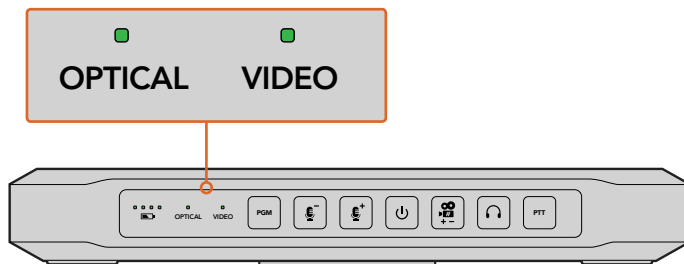
Wird am SDI- oder HDMI-Eingang ein gültiges Videosignal erkannt, leuchtet der VIDEO-Statusindikator des ATEM Camera Converters. Wird am Glasfasereingang ein gültiges SDI-Signal erkannt, leuchtet der OPTICAL-Statusindikator
