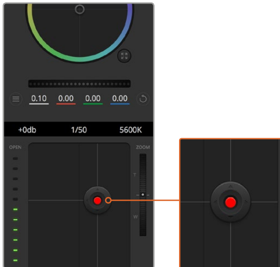
Ein rot erleuchteter Blenden-/Schwarzabhebungs-Button zeigt an, dass die jeweilige Kamera auf Sendung ist
